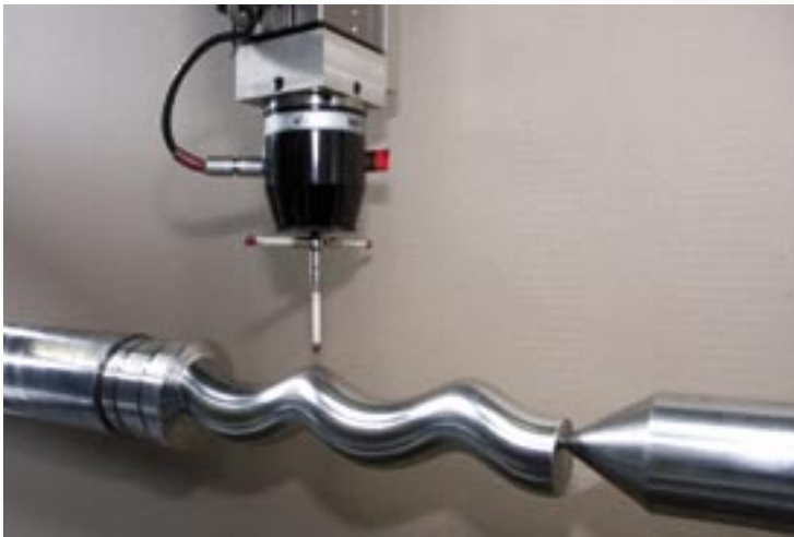
Från varje serie tages en rotor ut för avancerad toleransmätning.
